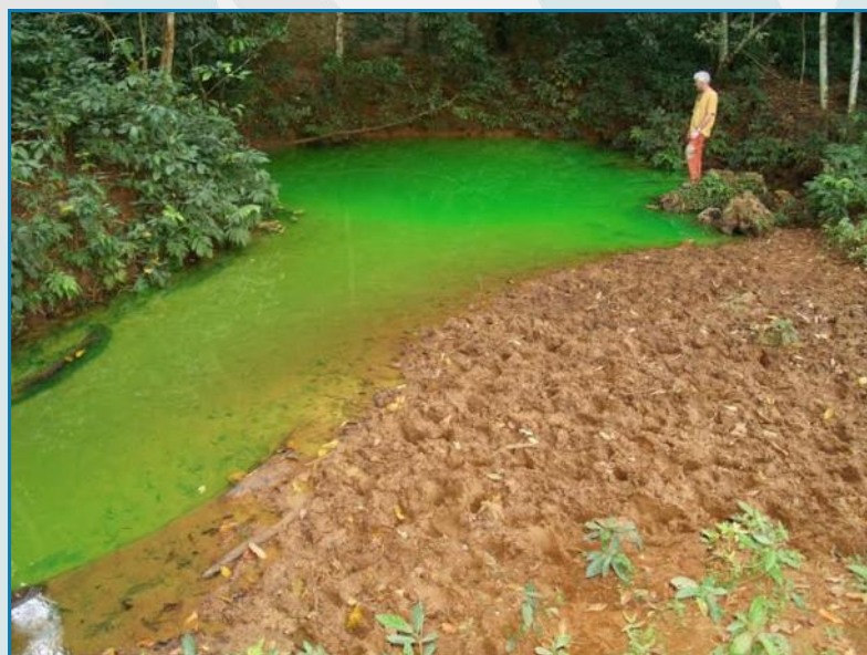
Antonio, contemplando un ensayo de trazador con fluoresceína
